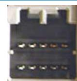
Рис.9. Разъем 5+5pin (Chrysler-2)
