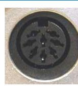
Рис.8. Разъем 8pin (Volvo, Honda, Chrysler-1)
