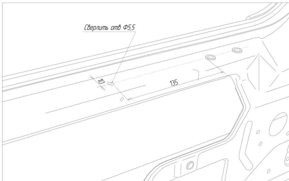
**Рис 1. Установка ЭСП в левую переднюю дверь.**
