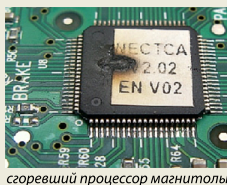
сгоревший процессор магнитолы
