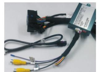
8. Видеоинтерфейс с кабелями. (Включается при переключении на заднюю передачу).
