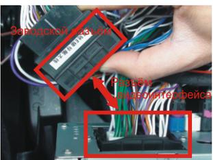
5. Подключите заводской 40pin разъем к видеоинтерфейсу, 40pin разъем видеоинтерфейса подключите к основному блоку на место заводского разъема.
