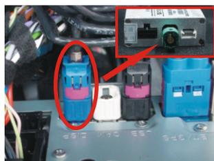
6. Отключите LVDS разъем от основного блока и подключите его к видеоинтерфейсу.
