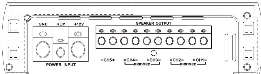
1. **POWER INPUT** – разъем для подключения питания. Подключите +12В к «+» аккумуляторной батарее, GND – к «-» аккумуляторной батарее или к кузову автомобиля, REM – к управляющему сигналу автомагнитолы.
