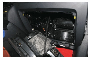
7. Видеоинтерфейс можно разместить за перчаточным ящиком.
