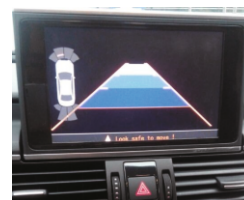
8. Отображение видеоинтерфейса. (Включается при переключении на заднюю передачу).
