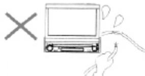
Запрещается менять предохранитель на проводе питания без консультации специалиста. Использование неподходящего предохранителя может привести к возгоранию или повредить прибор.
