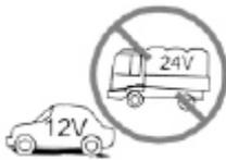
Данное устройство рассчитано на электросистему автомобиля с напряжением +12 В постоянного тока с минусом на корпусе, аппарат не предназначен для подключения к источнику питания +24 В (например, в автобусе, грузовике).
