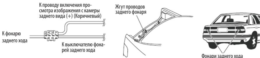
После выполнения такого подсоединения, когда проигрыватель включен, при включении заднего хода будет происходить автоматическое переключение на демонстрацию изображения с камеры заднего вида.
