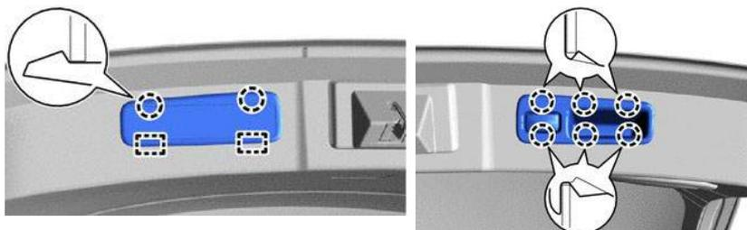
4. СНИМИТЕ КРЫШКУ ЗАМКА ДВЕРИ БАГАЖНОГО
