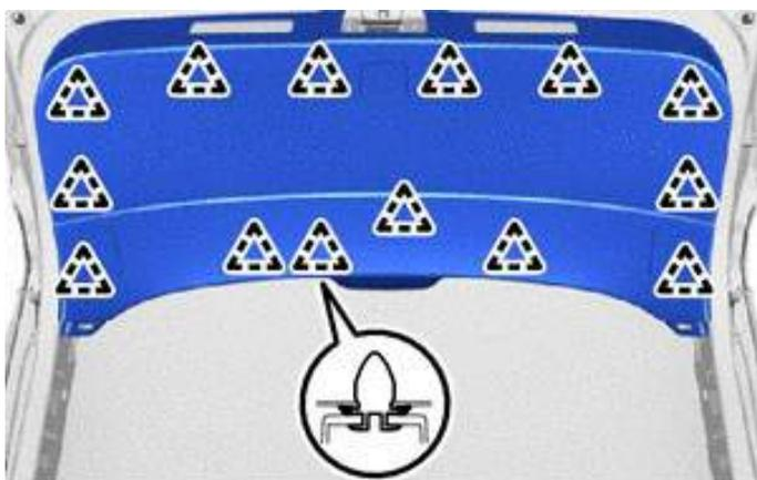
6. ОТВЕРНИТЕ БОЛТЫ И СНИМИТЕ НАРУЖНУЮ НАКЛАДКУ
