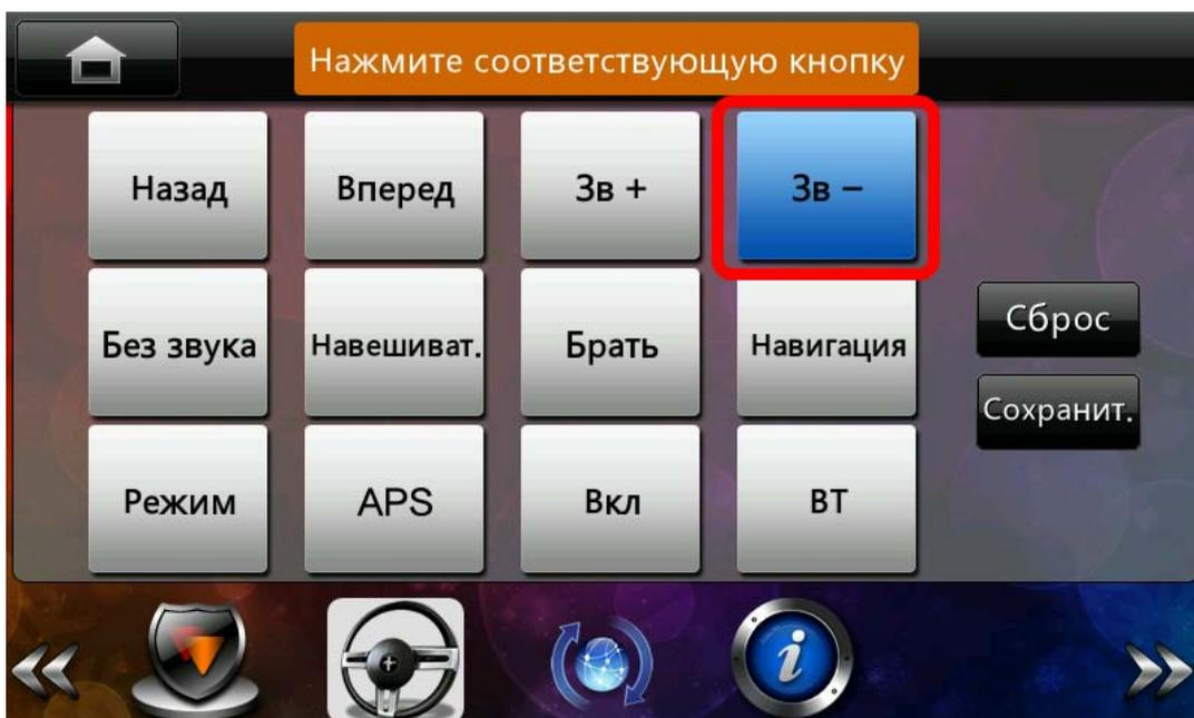
7. Если Вы в процессе программирования допустили ошибку, нажмите на экране кнопку «СБРОС» и повторите попытку программирования.
