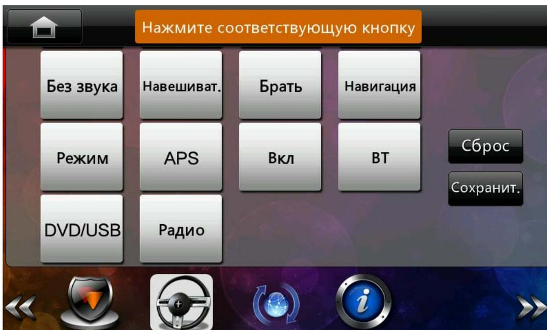
6. Нажмите и удерживайте на рулевом колесе кнопку, функция которой соответствует названию на иконке, выделенной синим цветом. После появления на иконке дополнительного значка отпустите кнопку на руле. Система перейдет к следующей функции.
