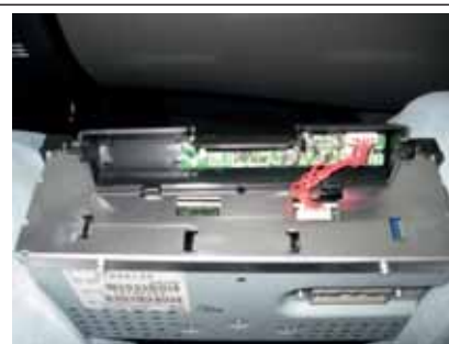
Отсоединяем блок электронного компаса от штатного модуля бортового компьютера.
